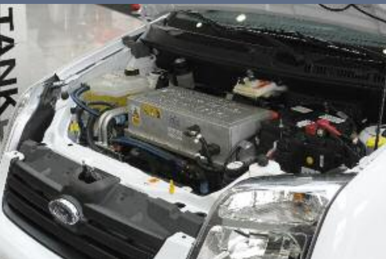
Unter der Haube: Elektromotor mit aufladbaren Batterien sorgt für die Fortbewegung
