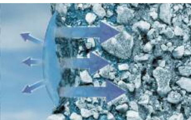
Bei weber.pas top dagegen werden die Tropfen gedehnt und dadurch wird die Verdunstungsfläche erhöht. Gleichzeitig zieht die ausgeprägte Kapillaraktivität das Wasser von der obersten Putzlage
