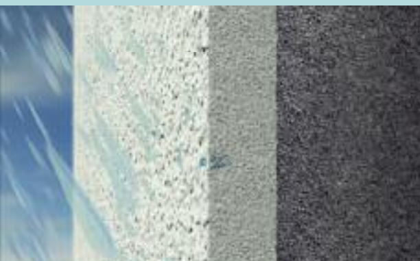
Bei stark wasserabweisenden (hydrophoben) pastösen Putzen bleibt die Oberfläche durch Tropfen in Putztaschen oder Taufilm auf der gesamten Fläche lange feucht
