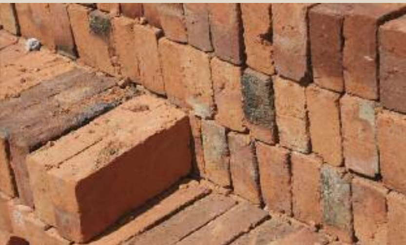
Die luftgetrockneten Lehmziegel, auch Adobes genannt, sind wasserlöslich
