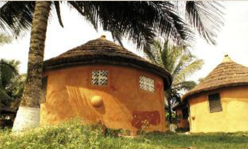
Lehmhütten wie diese in Ghana geben nachts die tagsüber gespeicherte Wärme ab
