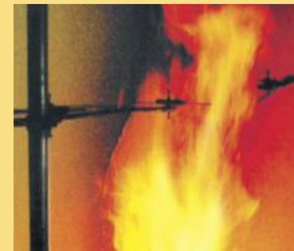
Der Bereich über dem Fenster wird im Brandfall (Zimmerbrand) besonders stark beansprucht
