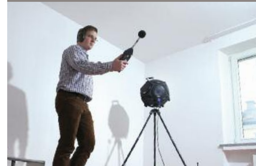
Nach Abschluss der Trockenbaumaßnahmen wurden Luft- und Trittschall durch ein Akustikbüro Luft- und Trittschall gemessen: Die erforderlichen Werte wurden mehr als erfüllt
